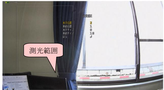
左の屋内側を測光範囲に指定すると、室内の明るさに合わせて露出を制御します。
